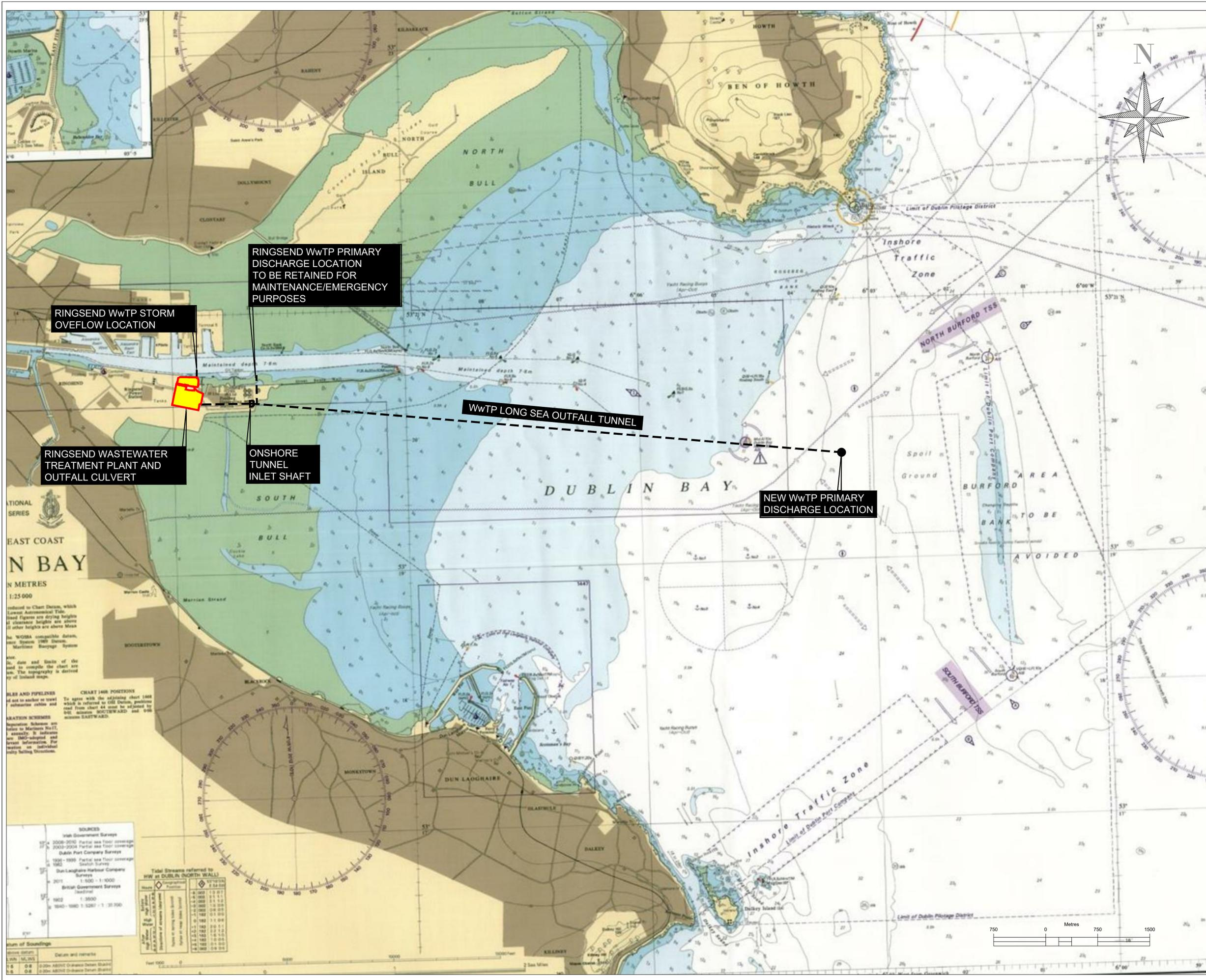
RINGSEND WwTP PRIMARY DISCHARGE LOCATION TO BE RETAINED FOR MAINTENANCE/EMERGENCY PURPOSES
